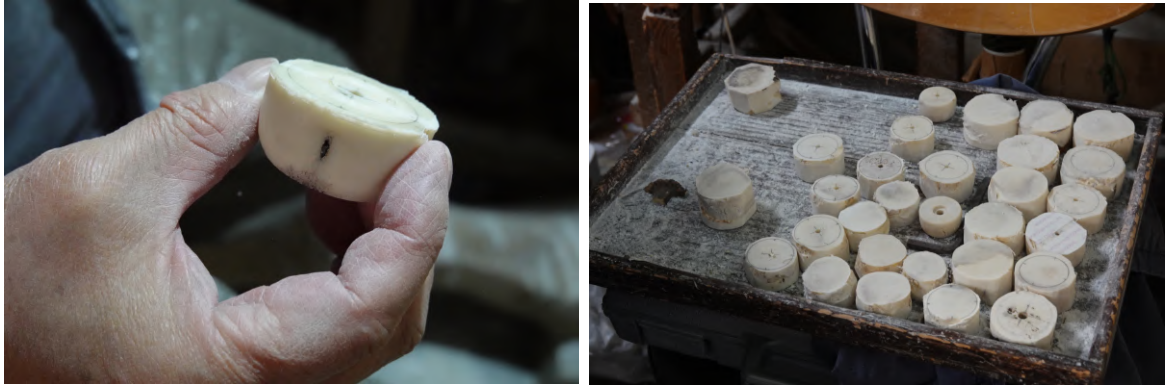
図4 サンダーによる加工とサイズの書き込み
