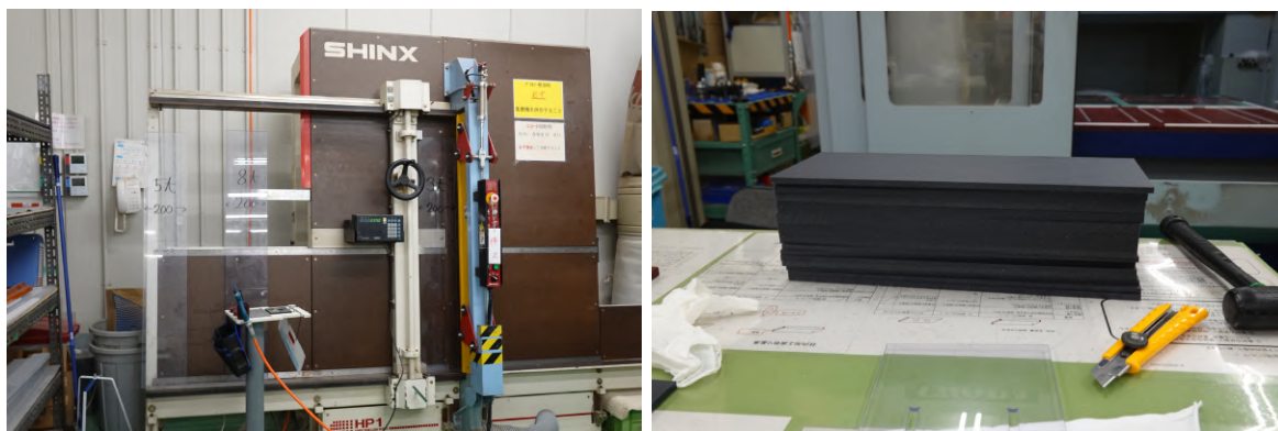
図1 MC ナイロン（MC801）素材の切り出し
