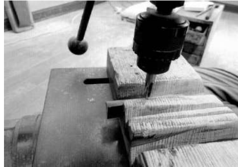
2 ポール盤（ドリル）で横穴を開ける
