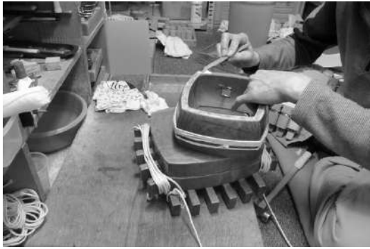
図 27 三味線胴の接着面に、もち米を原料とした寒梅粉（かんばいこ）を塗る
