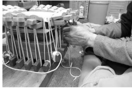
図 28 胴の上の和紙を下に引っ張るようにして接着する
