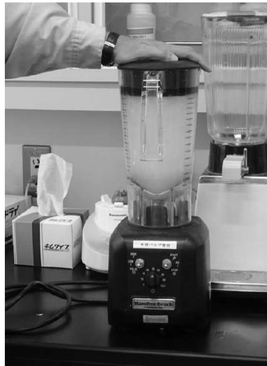
図10 叩解したパルプシートをミキサーで水中に分散させる
