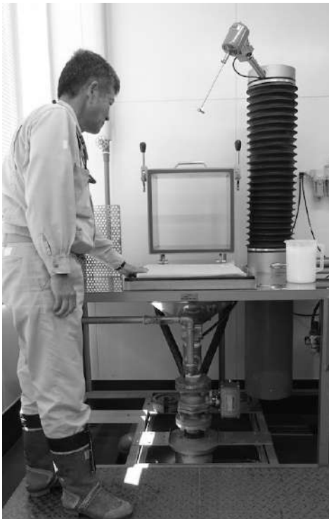
図15 大型タッピ手すき装置に紗を敷き、下の網に密着するのを待つ。
