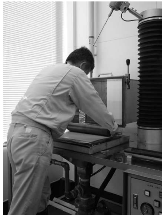
図21 ロールを転がして脱水
