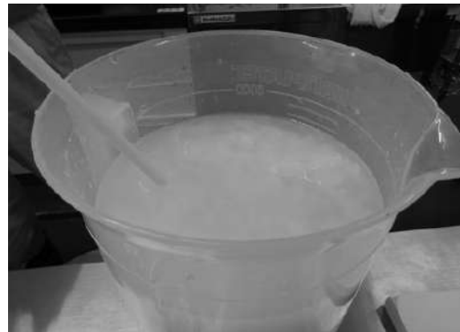
図11 硫酸アルミニウムを混ぜて少し凝固させる
