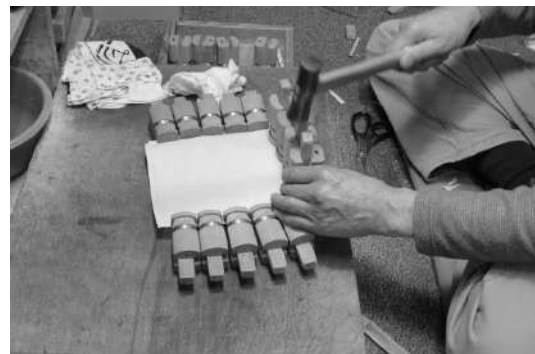
図 26 和紙の外周に沿って留め具を装着し、 木栓を打ち込んで固定していく
