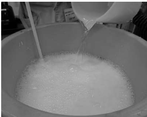
図13 総量10Lになるよう水を加える
